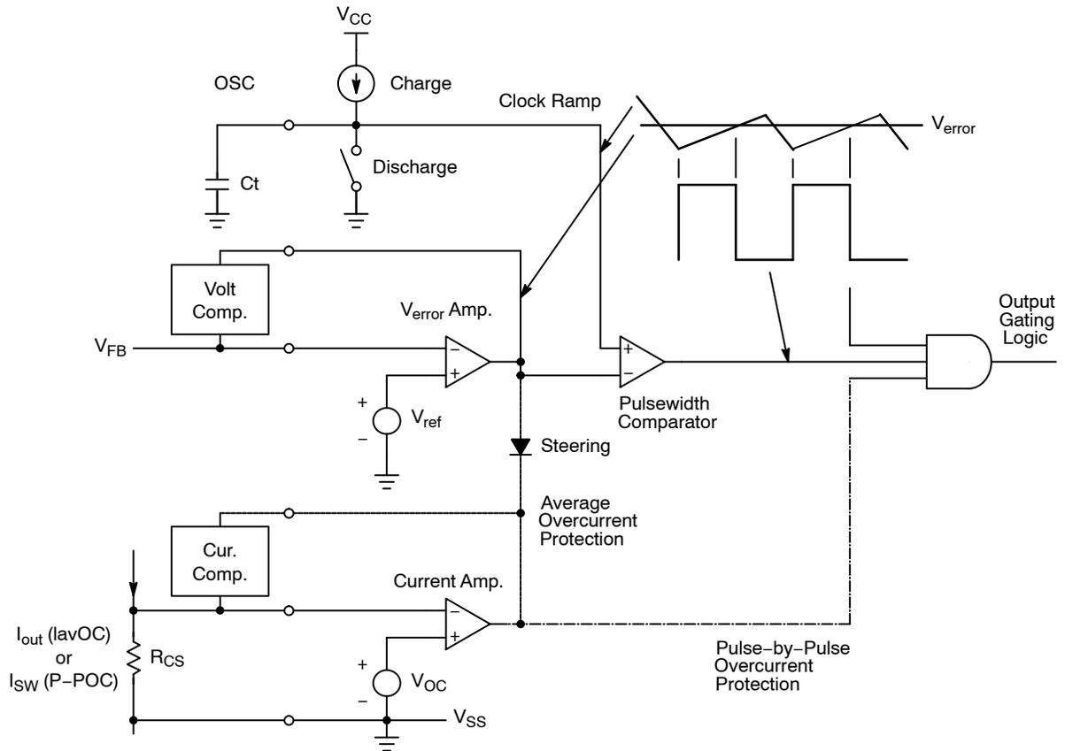
Figure 14. Voltage-Mode Control
